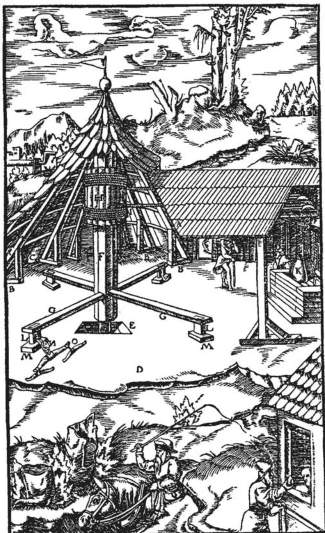
Abb. 17 Stollenentwässerung mittels Göpelanlage und mit Zugtieren (aus Agricola)
