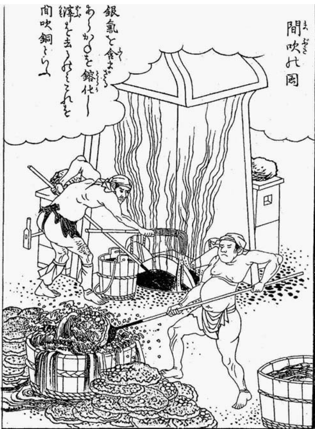
Abb. 9 Darstellung des Zwischenschmelzens: Hier wird das Kupfer aus mehreren Schmelzgängen zusammengeschmolzen und raffiniert. Zwei Arbeiter sind damit beschäftigt, durch sog. Scheibenreißen das metallische Kupfer zu bergen und im Wasserbottich abzukühlen. Hier ist recht instruktiv die Konstruktion des gesamten Schmelzofens, der Abzughaube, die beiden Düsen und das Kastenengebläse wiedergegeben. Der Schmelzofen ist teilweise abgedeckt.
