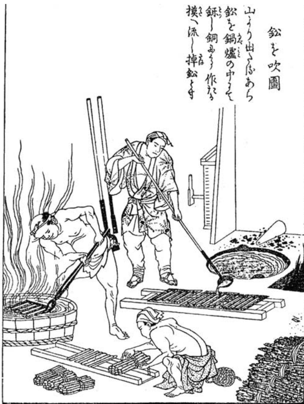
Abb. 14 Darstellung der Bleischmelze: Das aus den Bergen gekommene Rohblei wird in Topftiegeln geschmolzen und in Formen gegossen. Der Bleischmelzofen entspricht dem Kupferschmelzofen. Hier wird das flüssige Werkblei ausgeschöpft und in Formen gegossen. Diese werden in Wasser abgeschreckt. Die stangenförmigen Barren werden gebündelt und gestapelt.
