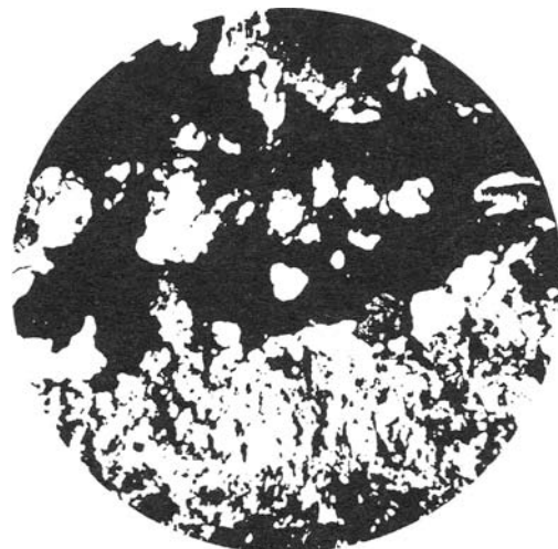
Taspin. Vorkommen 3a. Gemenge von Quarz und rekristallisiertem Bleiglanz: unten: Relikte von Stengelquarz. Dünnschliff Nr. 880, + N. Vergr.:24mal.
