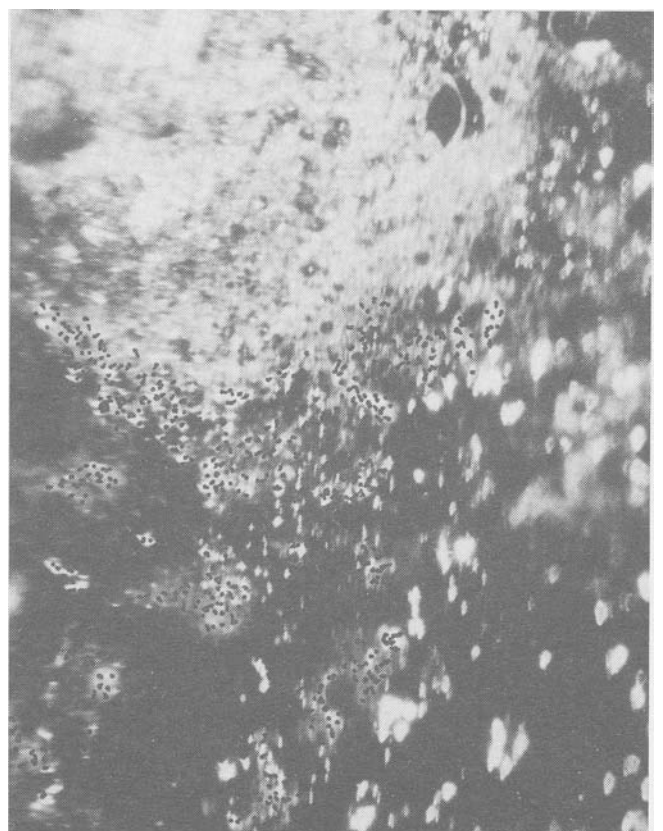
Abb. 24) Zeisiggrün (schwarzpunktiert) gefärbte Boraxschmelze als \text{MoO}_3 -Nachweis
