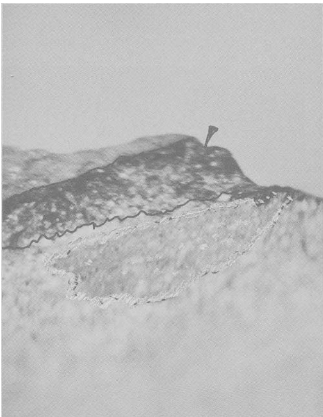
Abb. 23) Deckelrand mit Tiegelausbruch und Sublimat (Pfeil) schwarz, umrandet
