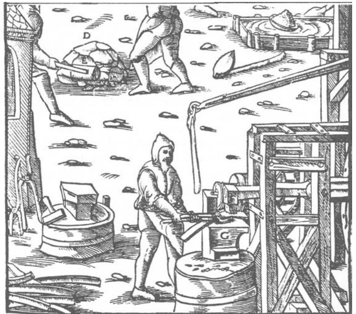
Der Herd A. Der Beschickungshaufen B. Der Schlackenabfluß C. Der Eisenklumpen (Masse) D. Die Holzhammer E. Der große eiserne Hammer F. Der Amboß G.
