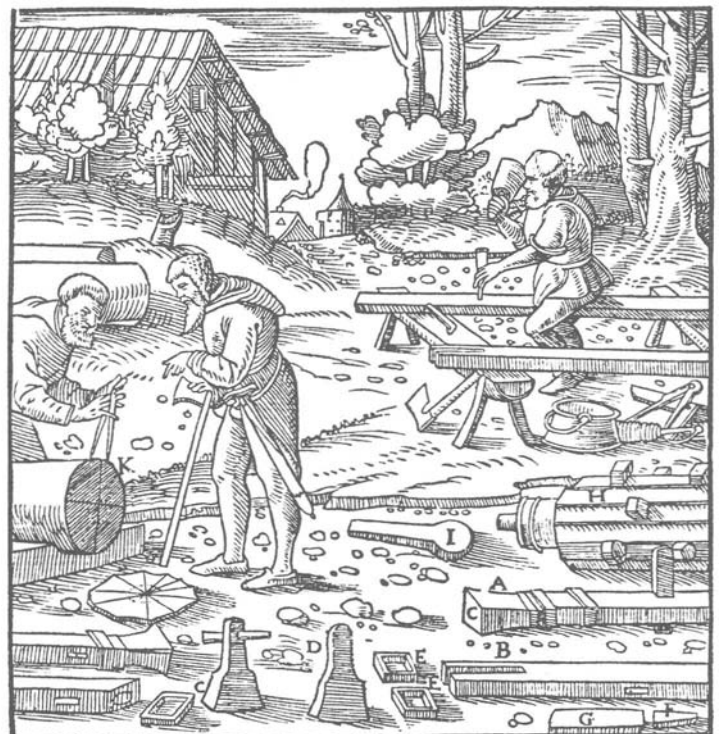
Ein Stempel mit Pochschuh A. Ein unten ausgeschnittener Stempel B. Der Pochschuh C. Ein anderer Pochschuh D 15 ). Rechteckige Eisenringe E. Ein Keil F. Ein Hebling G. Die eckige Welle H. Ein Däumling I. Der Zirkel K.
