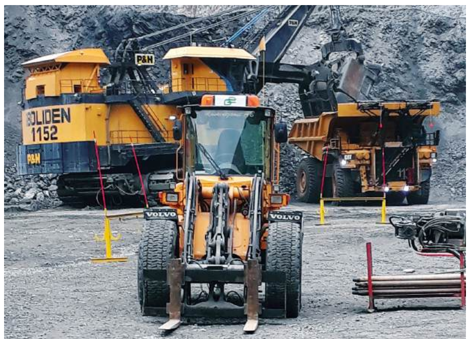
Elektrischer Verladebagger und Hybriddumper 2018 (diesel/elektrisch)
