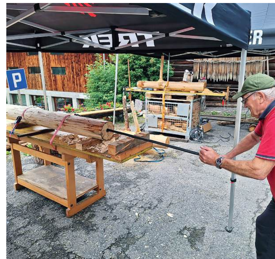
Teuchel bohren ist nicht einfach, denn das Loch muss in der Mitte des Baumstammes sein. Die Bohrversuche waren zahlreich und fast immer genau.
