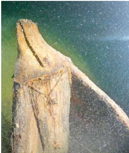
Bug mit Schlosserschrauben und Flacheisen
