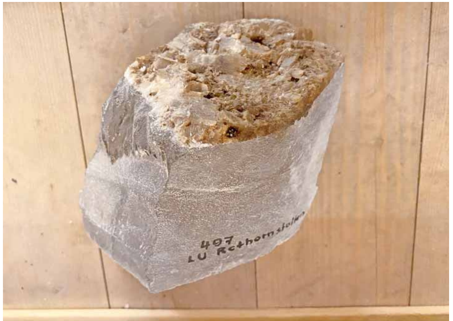
Beispiel eines Bohrkerns aus dem Rothornstollen Luzern. (Bild Elsbeth Rehm)
