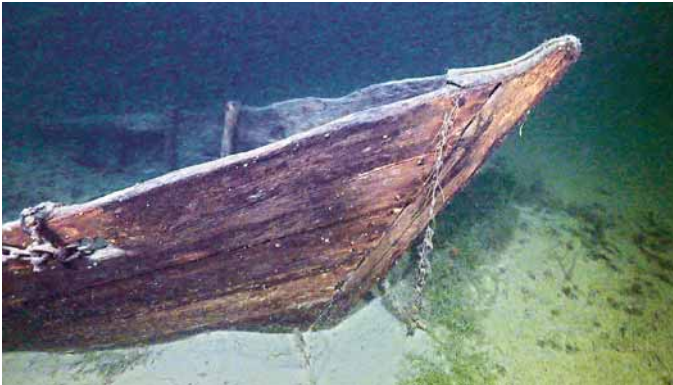
Bug (mit Eisenblech verstärkt) (Bild Markus Inglin)
