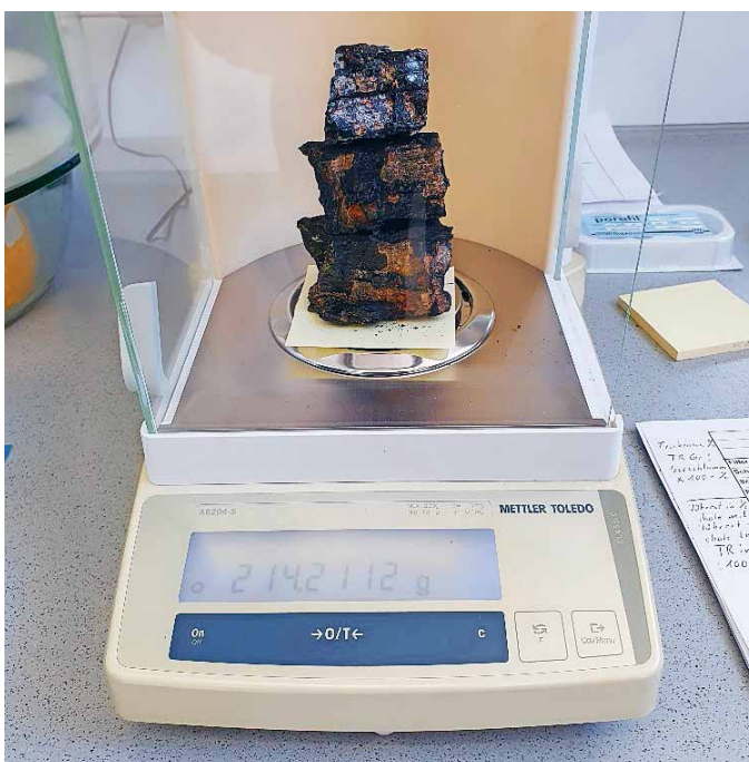
Laboruntersuchung: spezifisches Gewicht mittels Wasserverdrängung
