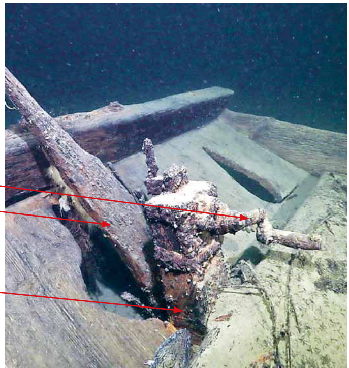
Stüürtüür mit Stockwinde-Hebevorrichtung, Baujahr ab 1870 Kurbel, Stockwinde und Stüürtüür (Bild Markus Inglin)
