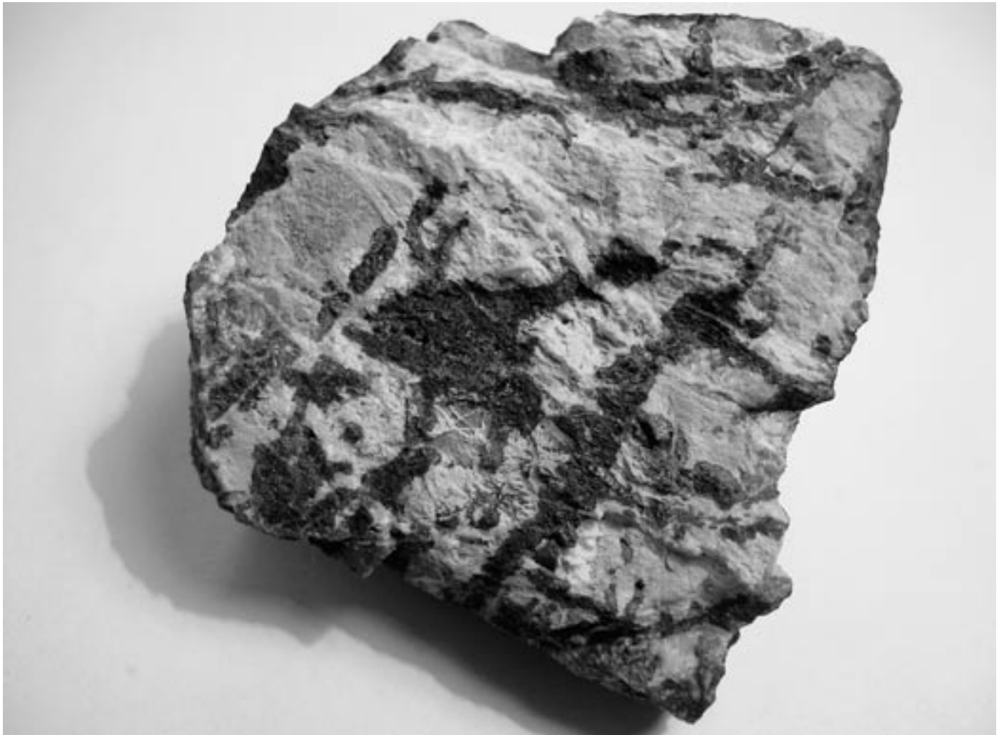
Abb. 1: Eisen-Mangan-Erz in Radiolarit (Stufenbreite 6 cm).
