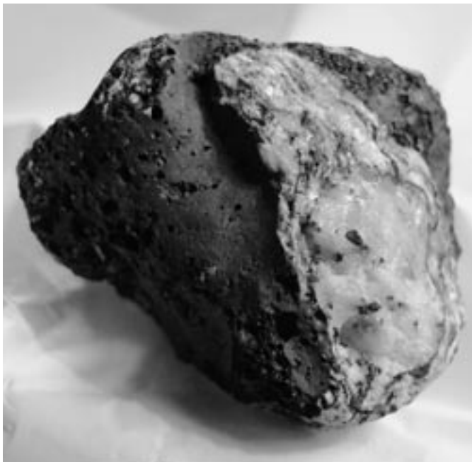
Abb. 6: Angeschmolzener Quarz in der Schlacke (Grösse der Schlacke 7cm).
