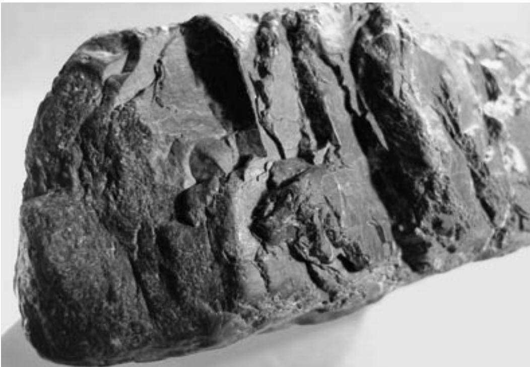
Abb. 2: Eisen-Mangan-Erz mit treppenförmigem Aufbau (Bildausschnitt 8 cm).
