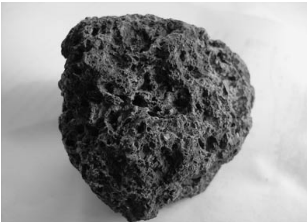
Abb. 9: Poröse Schlacke mit fettigem Glanz (Grösse 6 cm).
