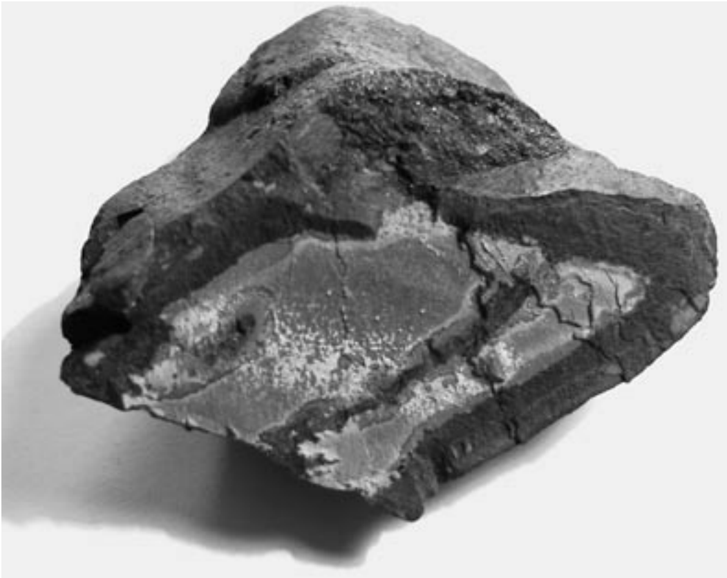
Abb. 4: Querschnitt eines abgerollten Eisen-Mangan-Erzes (Stufenbreite 8 cm).
