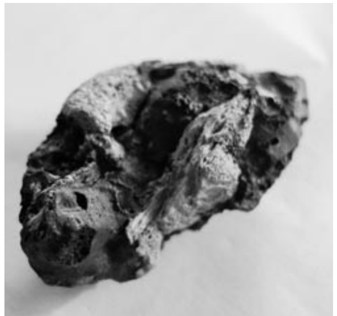
Abb. 7: Schlacke mit Einschlüssen (Schlackengrösse 4 cm).
