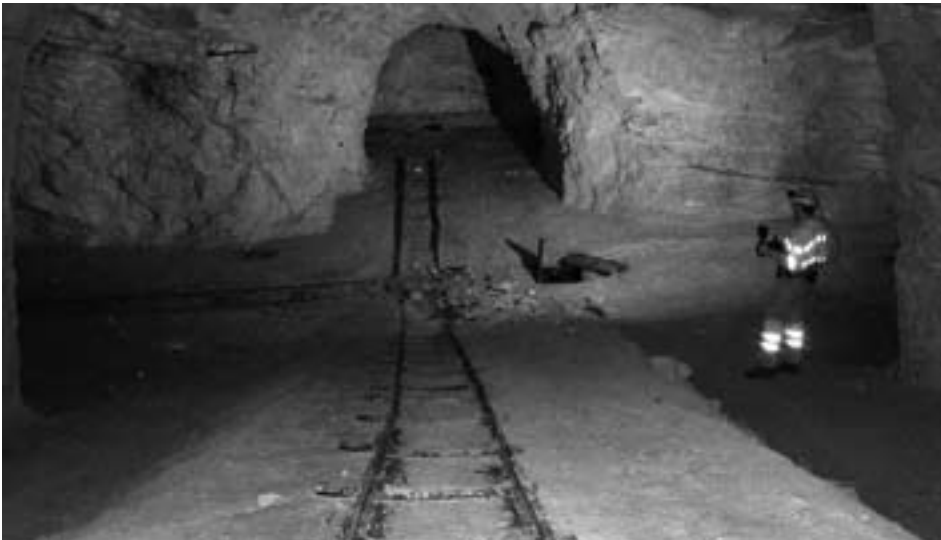
Der Bremsberg von der 2. zur 3. Sohle. Rechts ein kleiner Schacht, vermutlich um das Grubenwasser zu sammeln.
