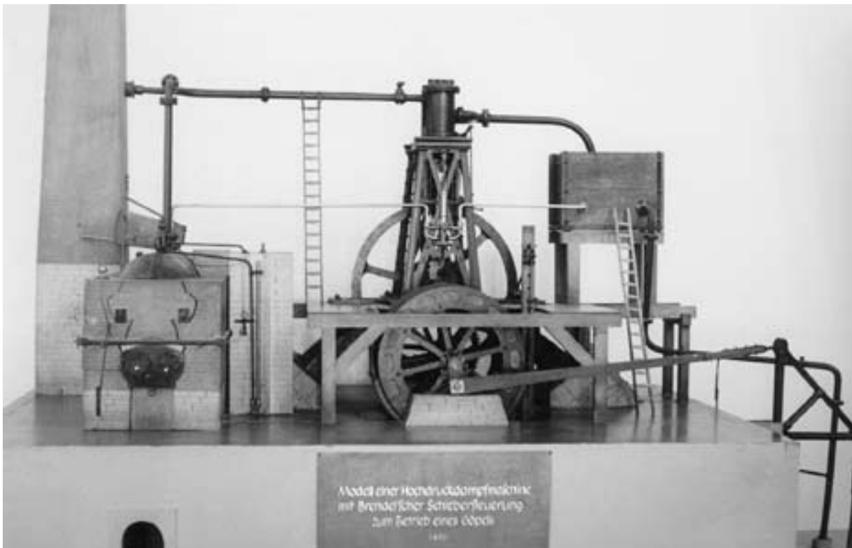
Abb. 8: Modell einer «Hochdruck»-Dampfmaschine mit Brendel'scher Plattenschiebersteuerung, in der Maschinenwerkstatt Halsbrücke nach den Vorgaben Brendels für die Maschinen der Lichtlöcher des Rothschnöberger Stollns um 1847 gebaut.
