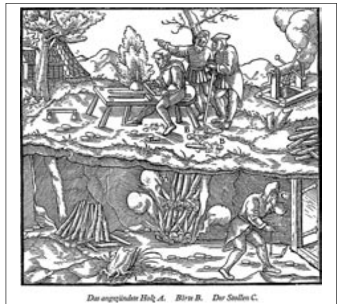
Abb. 3: Unter Tage entstanden Bleidämpfe durch das «Feuersetzen», durch das man das Gestein brüchig machte.
