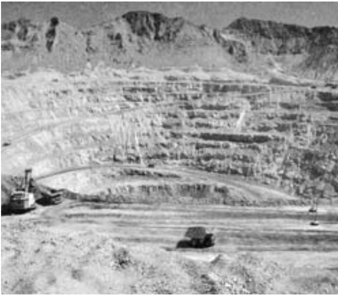
Abb. 3: Tagebau in der Kupfer-Gold-Lagerstätte Bajo de la Alumbrera, argentinische Anden. Täglich werden rund 100 000 Tonnen Erz abgebaut, was nach der Aufbereitung rund 500 Tonnen Kupfer und 60 Kilogramm Gold ergibt. Der elektrisch betriebene Bagger fasst um die 50 Tonnen Erz pro Schaufellladung; die Lastwagen haben eine Nutzlast von 250 Tonnen! Die Erzreserven in Bajo de la Alumbrera werden auf 3 300 000 Tonnen Kupfer und 380 Tonnen Gold geschätzt.
