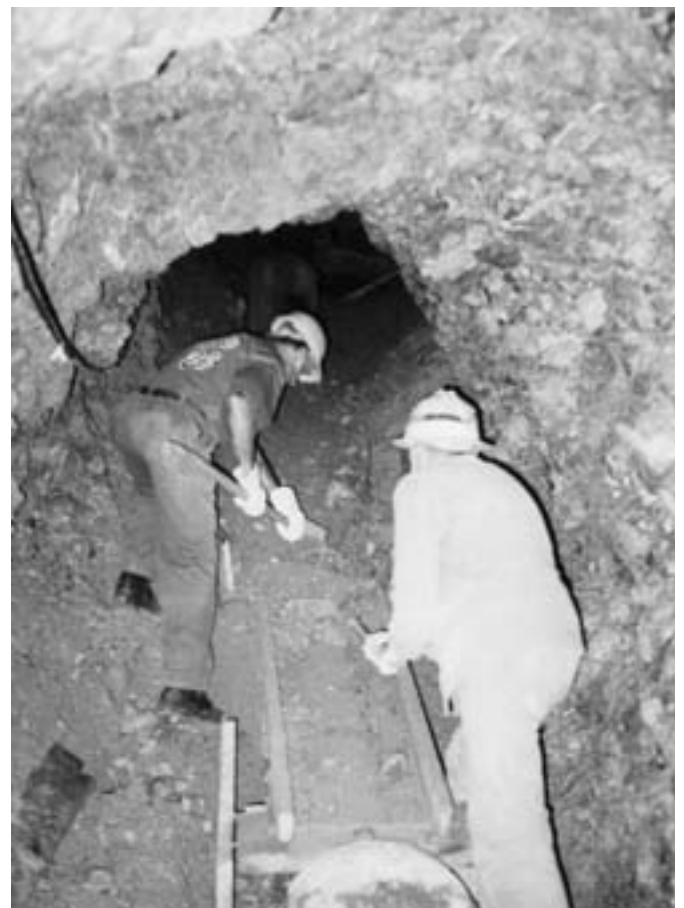
Abb. 1.4 und 1.5. Das "Förderband" ; am Fusse der Rutsche der Transportbehälter.
