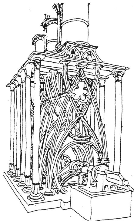
Abb. 13 Heuchler schuf 1831 die Vorlage für diesesgusseiserne Hüttengebläse, das als "Schwarzenberggebläse" als Zeuge des frühen sächsischen Maschinenbaus auf der Grube "Alte Elisabeth" gezeigt wird. Zeichnung M. Wagner
