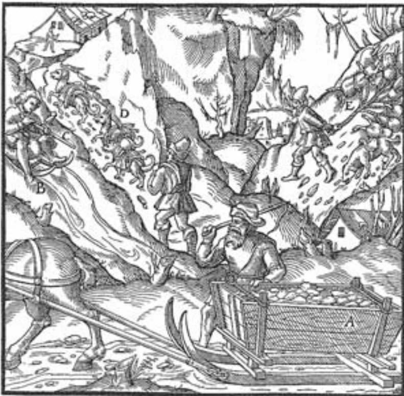
Abb. 7 Sackzug mit Schweinsbälgen im steilen Gelände und Schlitteneinsatz am Hang und auf der Ebene. Holzschnitt aus Agricola 1556
