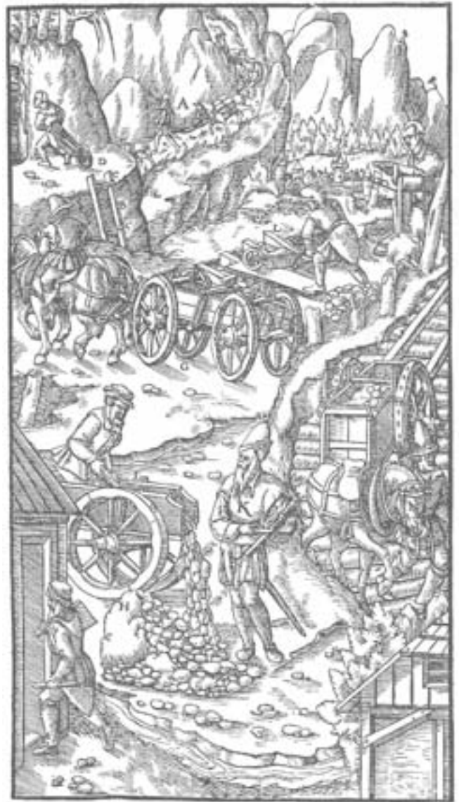
Abb. 3 Verschiedene Formen des Erztransports im Hochgebirge Holzschnitt aus Agricola 1556
