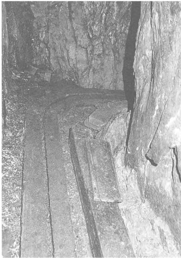
Kurve von aussen gegen innen fotografiert. Vom Tüchel sind nur noch Bretter zu sehen. Sehr schön sind dagegen die Schienen erhalten.
