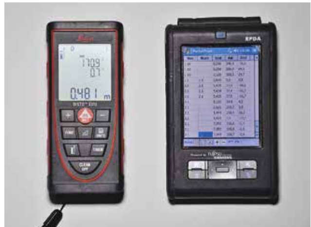
Fig. 2: Leica Disto mit zusätzlicher Kompass- und Neigungsanzeige auf dem Standard Display. Rugged-pda mit geöffnetem Datenerfassungsprogramm.
