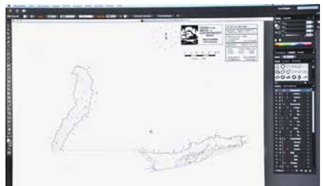
Fig.5: Reinzeichnung im Programm Adobe-Illustrator, als Vorlage ist eine bereits existierende PocketTopo Zeichnung angehängt.
